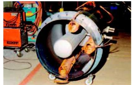
Kupferwärmetauscher für Wärmerückgewinnung aus Kälteanlagen (Kälte-WRG), zum Beispiel in Metzgereien. Damit eine möglichst grosse Oberfläche bei kleinem Kältemittelinhalt erreicht wird, werden viele kleine Kupferrohre parallel geschaltet. Im oberen Bereich wird zuerst die Heissgasenergie abgegeben und anschliessend im unteren Bereich so gut wie möglich kondensiert.
