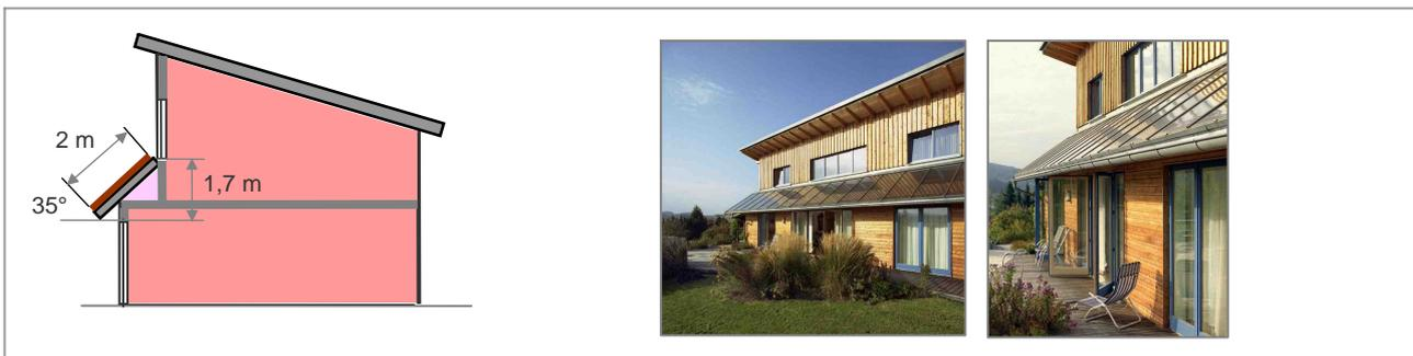
Der Platz zwischen Oberkante Fenster EG und Unterkante Fenster OG reicht – je nach Hausbreite – nur für eine Kollektorfläche von 25 – 30 m² bei einer Neigung von 35° aus. In dem rechts dargestellten, 20 m breiten Zweifamilienhaus konnten ausnahmsweise 50 m² untergebracht werden (Kollektormaß 2,5 x 20 m). Um eine Brüstungshöhe von 1m im Obergeschoß nicht zu überschreiten wurde in den südseitigen Räumen ein Po-dest eingebaut. Andernfalls hätte die Raumhöhe im Erdgeschoß erhöht werden müssen.
