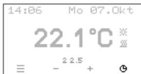
Durch Drücken der **rechten Taste** kann die Betriebsart gewechselt werden. Über der rechten Taste wird die aktuelle Betriebsart angezeigt.
