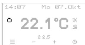
Wurde ein Zeitraum in der Zukunft eingestellt wird anschließend in der Raumregler-Anzeige links oben das Symbol für das Urlaubsprogramm angezeigt.
