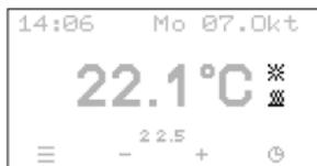
Rechts neben der Temperaturanzeige wird der momentane Betriebszustand des Heizkreises angezeigt.
