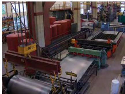
Ausgehend vom 16-Tonnen-Stahlcoil werden Speicher in Serie oder individuell produziert
