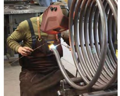
Im Speicher integrierte, richtig angeordnete Wärmetauscher finden automatisch den optimalen Arbeitspunkt und geben die Wärme dorthin ab, wo sie hingehört. Damit wird eine Umwälzung im Speicher verhindert. Integrierte Glattrohr-Wärmetauscher zeichnen sich auch durch geringere Anfälligkeit auf Verschmutzung und somit eine langfristig konstante Leistung aus.
