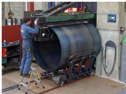
Die Längsschweissnaht wird automatisch ausgeführt
