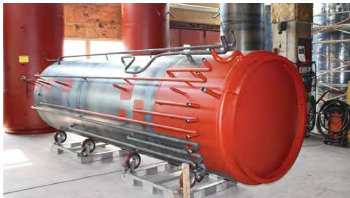
In Arbeit: Solarspeicher mit **angeschweisster Verrohrung**
