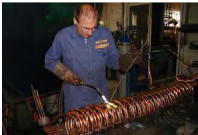
Speicher für **Wärmerückgewinnung** aus Kältemaschinen benötigen der Leistung angepasste Kondensatoren, die wir nach Bedarf herstellen
