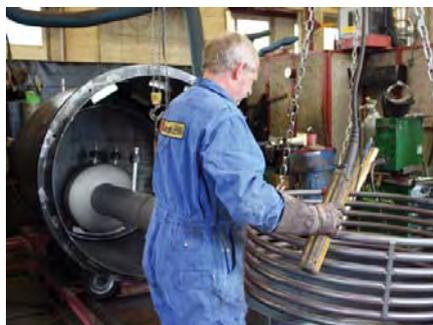
Wärmetauscher, Boiler und Stützen werden angeschweisst
