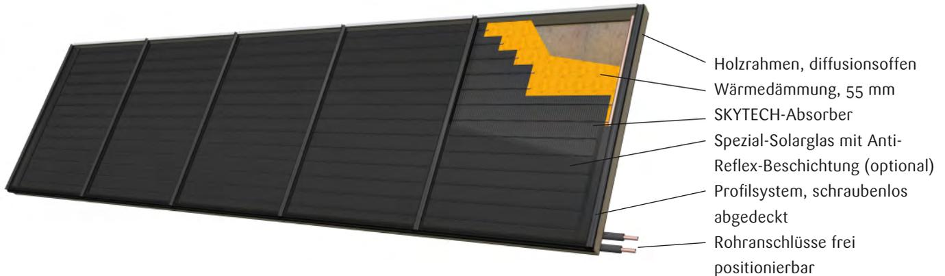
Leistungs- und Qualitätsprüfung nach ISO, DIN, EN, solar-keymark
